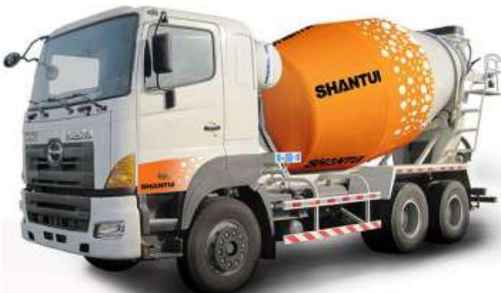
Автобетоносмеситель – главный помощник в работе с бетоном, ведь он производит бетон не только статично на строительных площадках, но и во время перемещений между объектами. Этому способствует особая конструкция лезвий и барабана, подогрев резервуара для воды, элементов двигателя и кабины.
