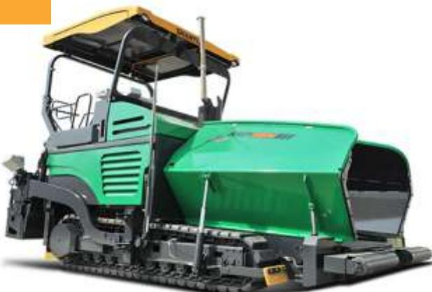
Асфальтоукладчики Shantui оснащены дизельными двигателями с турбонаддувом Deutz или Shanghai Diesel, характеризующимся низким уровнем шума, низким уровнем выбросов, соответствует экологическому стандарту ЕВРО 3. Техника обладает сильной движущей силой, высокой надежностью и долговечностью, большой возможностью адаптации. Система нивелирования MOBA. Электронная панель управления Siemens.
