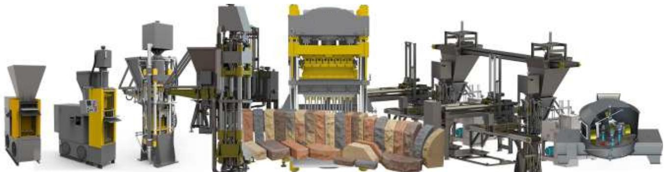
Технология производства гиперпрессованного кирпича – полусухое гиперпрессование – основана на прессовании при высоком давлении промышленных отходов с содержанием гипса, известняка, базальта, бетона и ракушечника, влажностью 3–6%.
