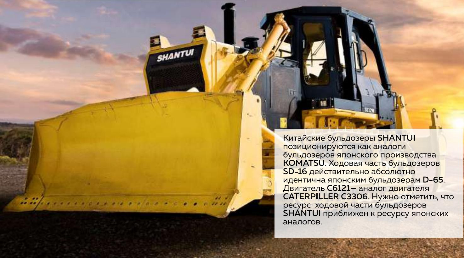
Китайские бульдозеры SHANTUI позиционируются как аналоги бульдозеров японского производства KOMATSU. Ходовая часть бульдозеров SD-16 действительно абсолютно идентична японским бульдозерам D-65. Двигатель C6121 – аналог двигателя CATERPILLER C3306. Нужно отметить, что ресурс ходовой части бульдозеров SHANTUI приближен к ресурсу японских аналогов.
