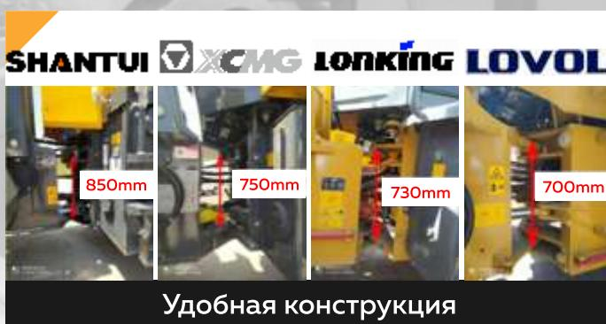
Удобная конструкция корпуса, позволяет производить диагностику гидравлической системы и коробки передач, без снятия кабины.
